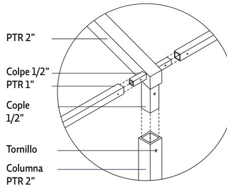
Las estructura del techo deberá tener apoyos a cada 60cm para soportar la lámina del techo. Las láminas traslúcidas se anclan a la estructura usando cinta doble cara.
