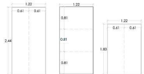
Las láminas planas deben colocarse con soportes máximo a 81 cms para evitar el pandeo.
